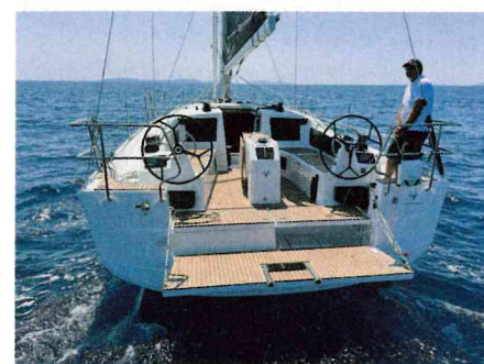
Die breite Badeplattform ist hoch über dem Wasser angeschlagen. Nur gut bei Wellen.
