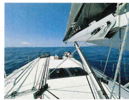
Einfach und effizient. Die Großschot wird über beide Seiten ins Cockpit geführt.
